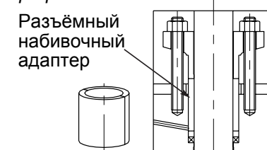
Рисунок 5.1С ПРИМЕЧАНИЕ: Длина раздельного набивочного адаптера увеличена таким образом, что он выдается из корпуса сальника настолько, чтобы его можно было извлечь вручную
